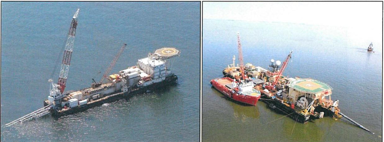
**Abb. 50** Typische ankerpositionierte Verlegebargen
